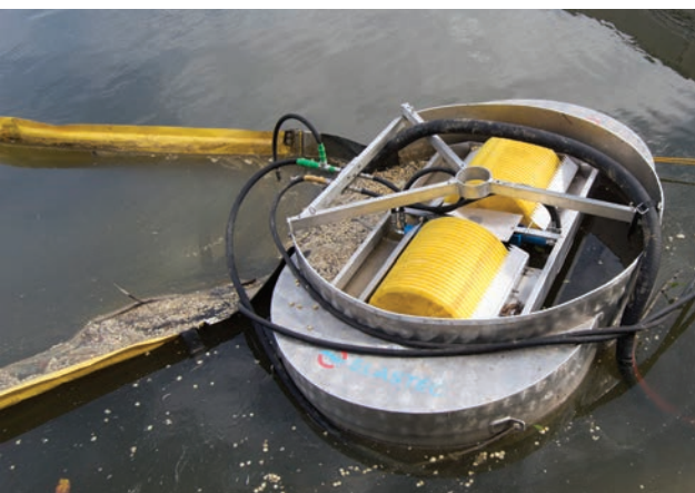
Desnatador Circus con bomba E150 & vertedero interno
